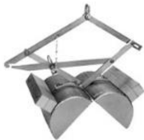
Ponar Sampler ( www.envirotools.hu )
